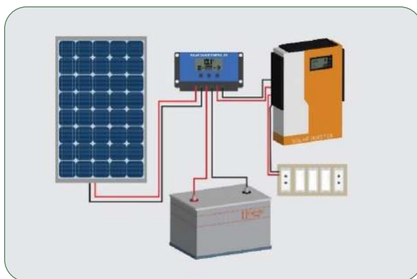
Figura 1. Esta figura muestra un esquemático para la conversión de un panel solar (imagen usada con licencia shutterstock.com).
